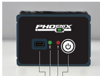
USB Indicador carga de bateria ON / OFF Indicador de status
